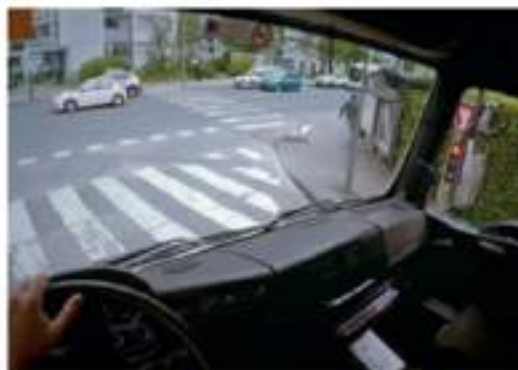
Depuis sa position de conduite, le chauffeur ne voit pas le cycliste qui s'est positionné sur sa droite.
